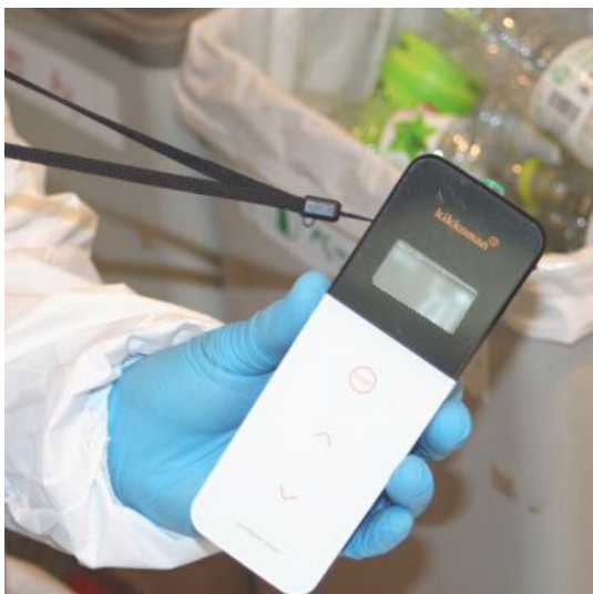
●ATP検査：清浄度検査 (施工前・施工後の残存菌の測定)
